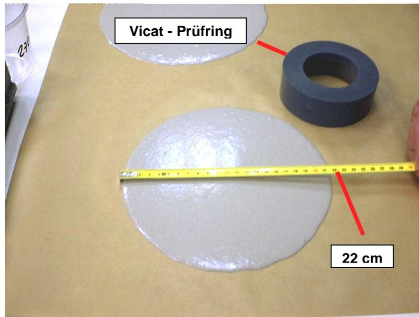
Die richtige Konsistenz des Wicoplan Estrichs wird durch das Fließmaß bestimmt und ist entscheidend für die Qualität sowie die Oberfläche des Estrichs.
